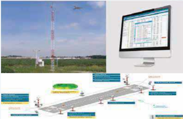
Figure 4 በዓለም አቀፍ የአውሮፕላን ጣቢያዎች የሚገኙትን Automatic Weather Observing System (AWOS)
